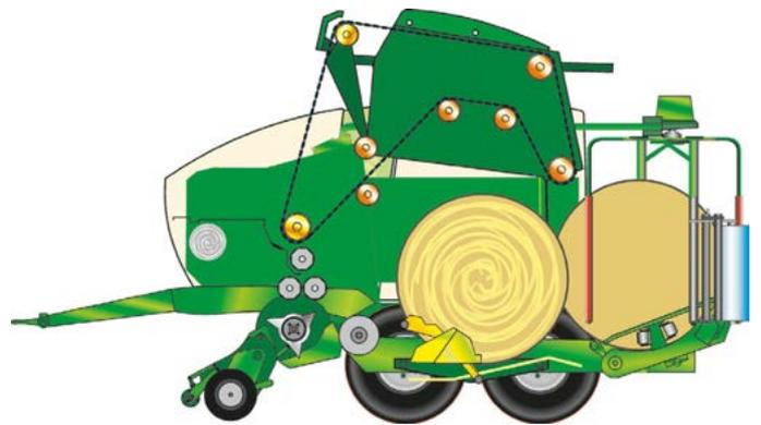
**Le combiné presse-enrubanneuse chambre fixe à diamètre variable Comprima CF 155 XC**
