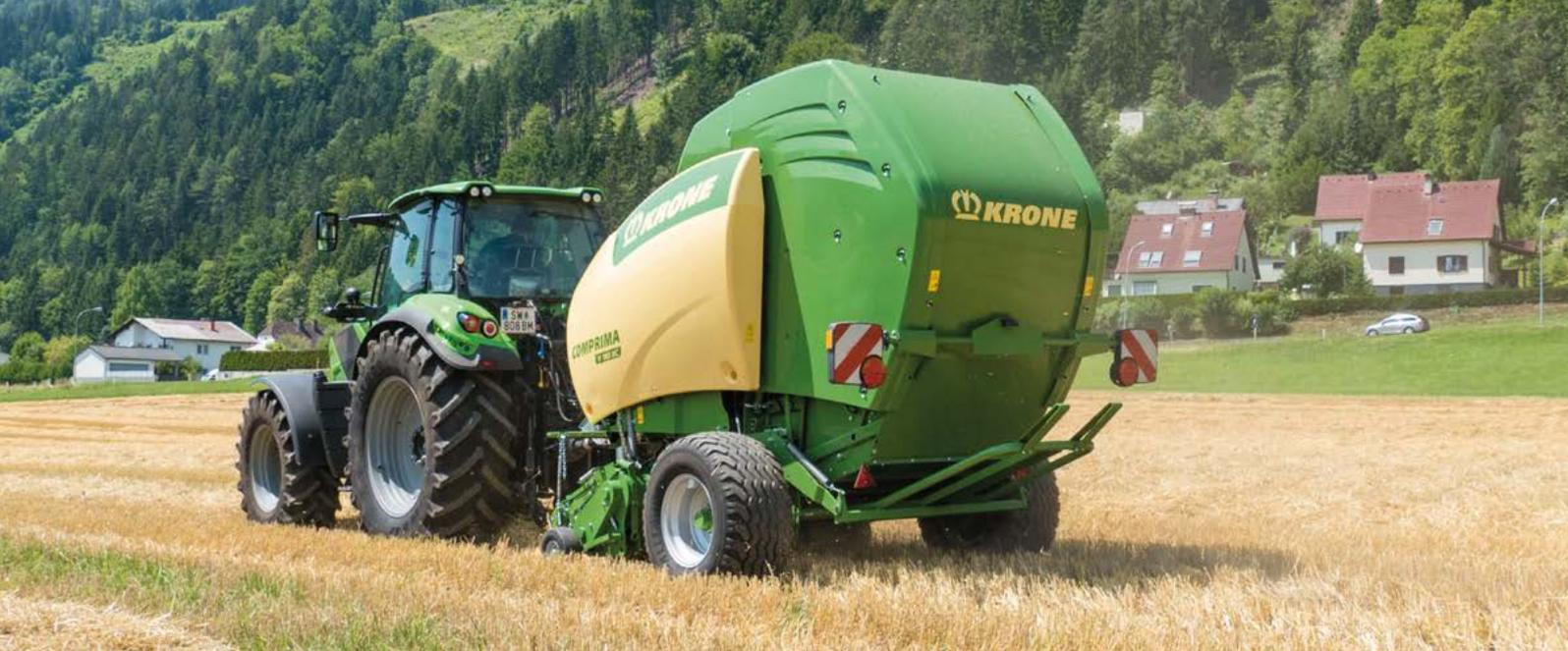
Comprima à chambre fixe à diamètre variable
